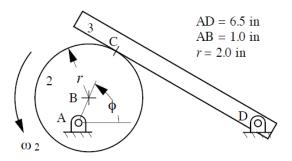
۴- در مکانیزم زیر، عضو ۲ با سرعت زاویه ای ثابت ۱۰ rad/s در جهت ساعتگرد دوران می کند. مطلوبست تصویر سرعت و شتاب عضو چهار (مکانیزم با مقایسه ۱:۱ رسم شده است).
